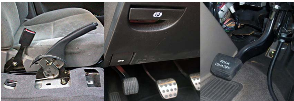
Pozicione të aktuatorëve të frenave të parkimit
