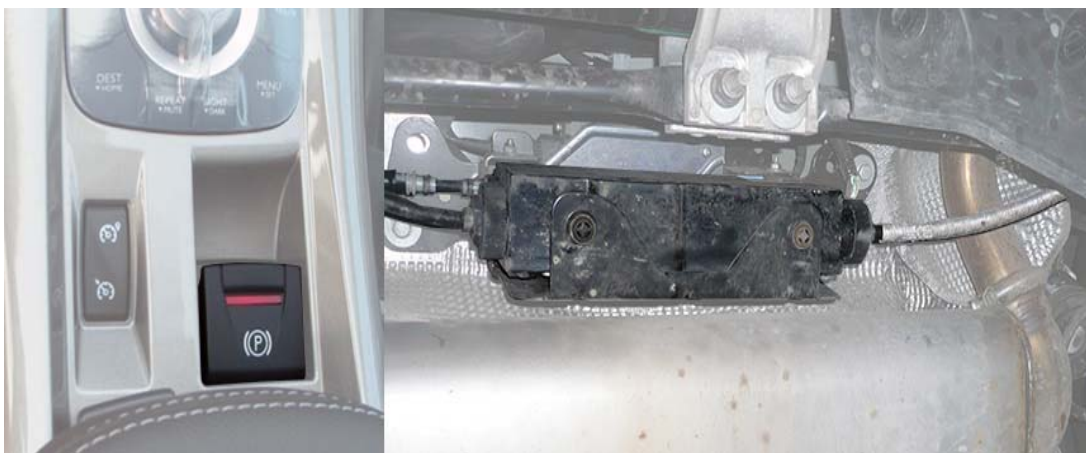
Butoni dhe motori i frenimit elektrik
