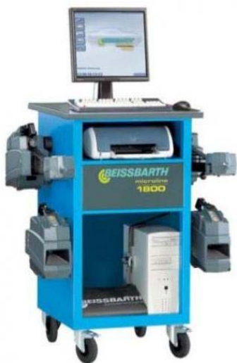
Pajisje per sistemi e drejtimit automatike
