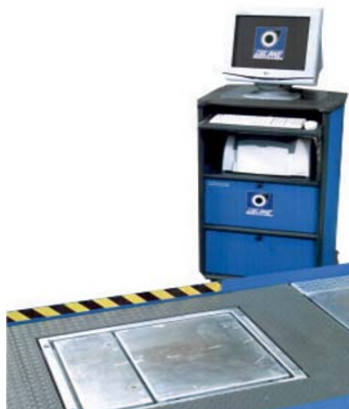
Bankë provë për amortoizatorët dhe
